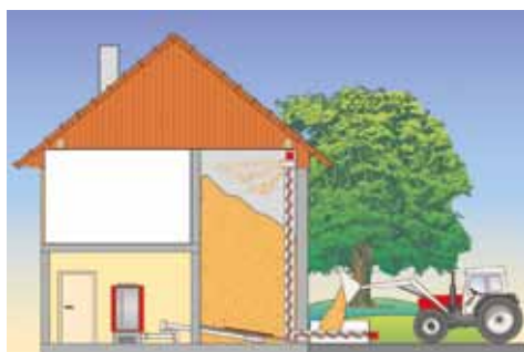
Vulsysteem voor opslagruimte over twee verdiepingen.
