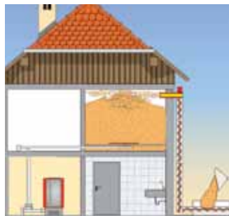
Vulsysteem voor opslagruimte op eerste verdieping.
