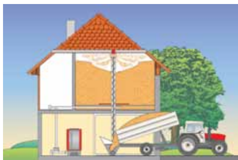
Vulsysteem voor opslagruimte op eerste en tweede verdieping.
