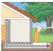
Vulsysteem met kuip in de grond verwerkt.
